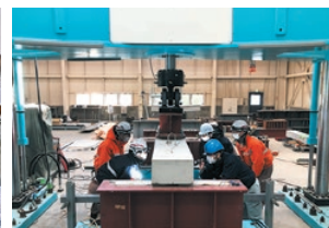
床版水平ひび割れ 注入アンカー 曲げ試験
