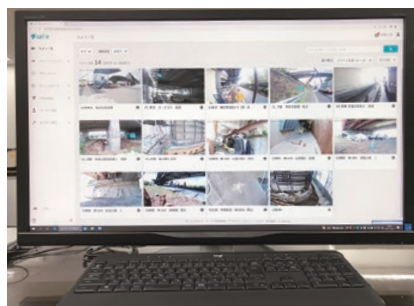
ウェアラブルカメラを利用した遠隔現場確認
