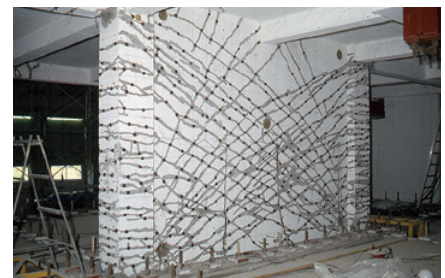
1981年 建設省建築研究所の日米共同大型耐震実験で ビックス工法が採用に
