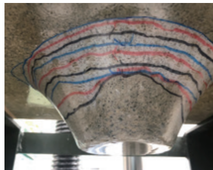
1液ウレタン樹脂を用いた透明はく落対策
