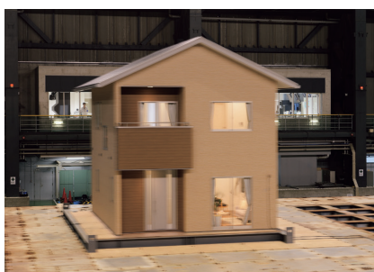
▶ 震度7の揺れでも倒壊しない高い耐震性を証明
