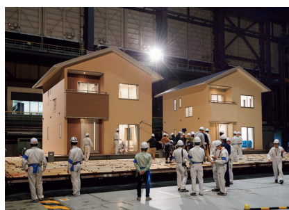
▶ 震度7の大地震を想定した振動実験
