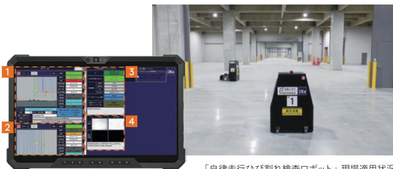
「自律走行式ひび割れ検査ロボット」制御画面
