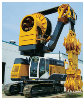
狭隘地でのソイル壁構築(CSM工法)を可能にするクアトロサイドカッター
