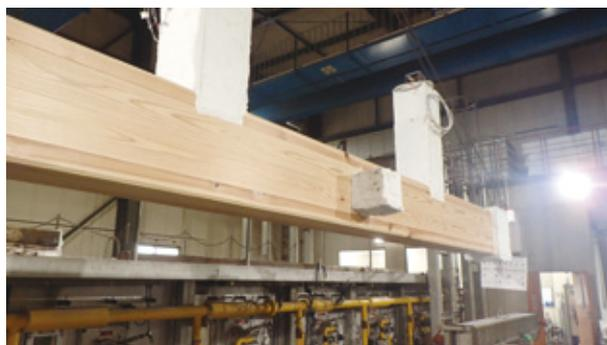
「モクタスWOOD (準耐火) はり」加熱試験体
