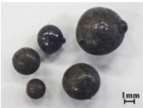
電気炉酸化スラグ細骨材
