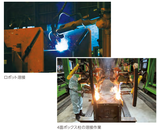
4面ボックス柱の溶接作業
