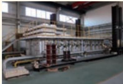
大型水平加熱炉 (大阪工業大学八幡工学実験場)
