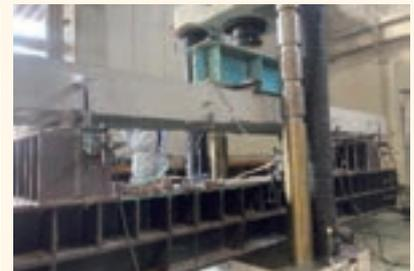
被災したCFCCスラブの耐荷性能評価
