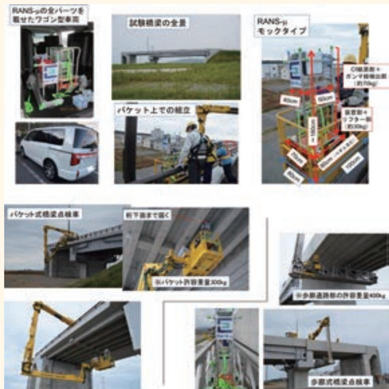
福島ロボットテストフィールドでのRANS- $\mu$  モックタイプの搭載試験
