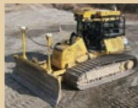
当社は2013年より遠隔操作や自動・自律で運転する建設機械「TiROBOシリーズ」の開発を進めており、土砂山を検出し押し経路を自ら決定する自律制御型ブルドーザーを開発・適用を実現しました。
