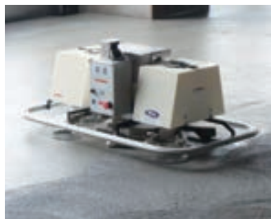
コンクリート床仕上げロボット 「T-iROBO ® Slab Finisher」
