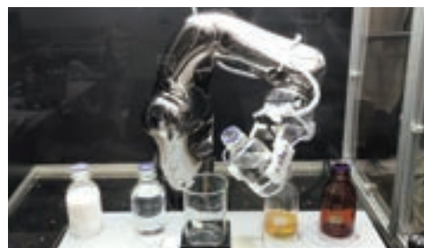
AIを搭載した力触覚伝達型遠隔操作システムによる液体秤量作業
