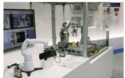
力触覚操作側ロボット(手前)、遠隔側ロボット(奥)
