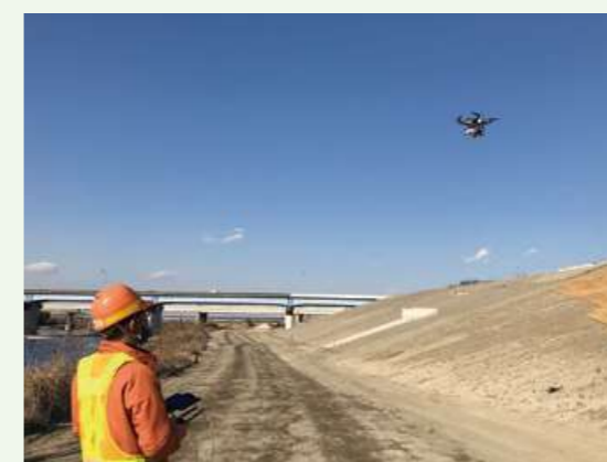
ドローンによる測量
