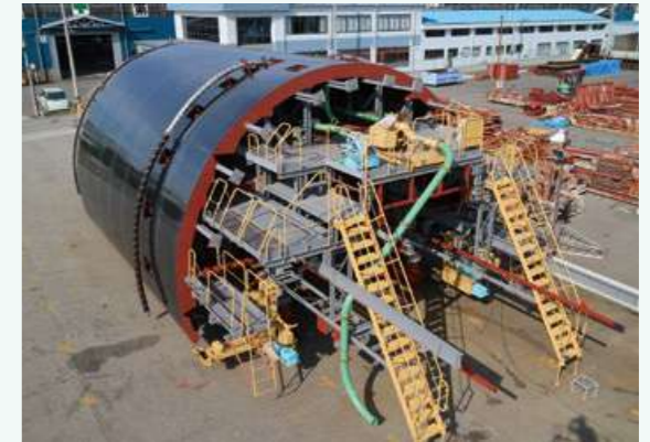
「OTISM/LINING®」のホース伸縮式連続打設システム
