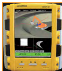
MGのモニター画面(写真左)を確認しながら工事機械を操作することで、精度の高い施工を実現
