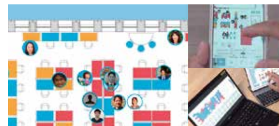
位置情報システム: 社内外問わずスマホやPCからフロアレイアウト図上で、個人の所在をリアルタイムで確認できる
