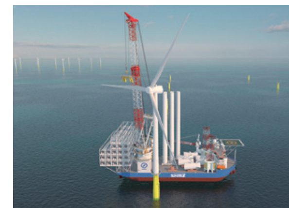
SEP船による風車据え付けの様子(予想図)
