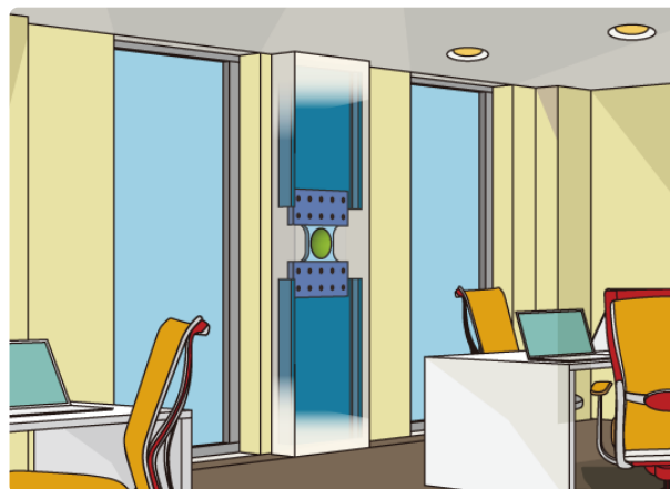
レンズダンパー設置状況
