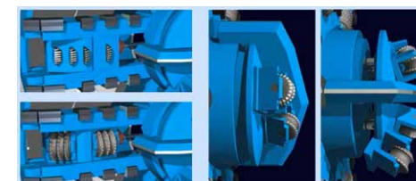
カッタービットの交換状況
