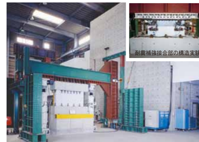
耐震壁の構造実験
