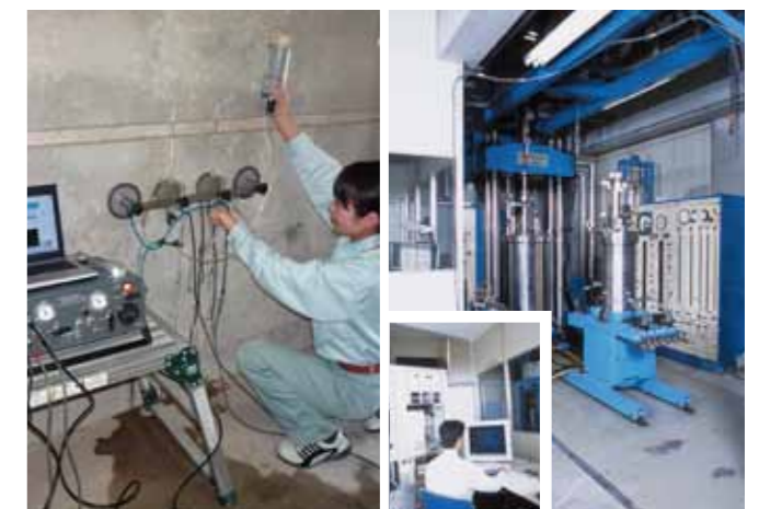
コンクリート表面吸水試験装置
