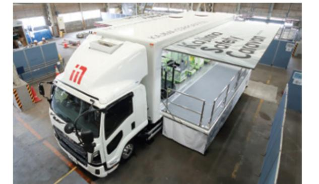
中型トラック（最大積載11t）をベースにした訓練車に、危険体感訓練の研修コンテンツ9種類を搭載
