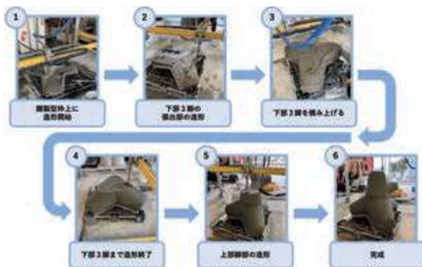
3Dプリンタで造形したテトラポッド (0.5t型相当)
