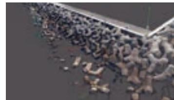
既設テトラポッド空撮写真の3D画像処理化
