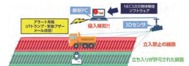
立入禁止エリア侵入検知システム概要図
