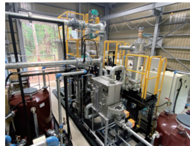
小型木質バイオマスガス化発電におけるガス化ユニット 半炭化処理した木質チップをガス化し発電機に送る装置
