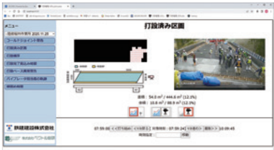
打設済み区画の表示、コールドジョイント発生 の恐れがあると警告の表示が出る
