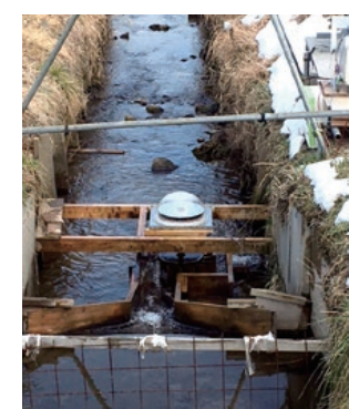
茨城県石岡市で試験運転中の発電装置
