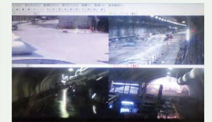
webカメラを用いたタブレットによる坑内状況確認
