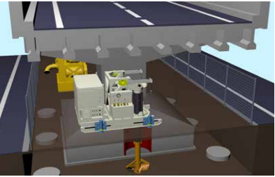
「超低空頭場所打ち杭工法」 狭い施工空間においても大口径の杭の施工を実現できます。施工実績260本以上。
