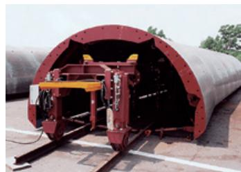
型枠であるスキンプレート部と支保工部の分離ができる構造
