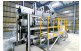
半炭化材製造装置
