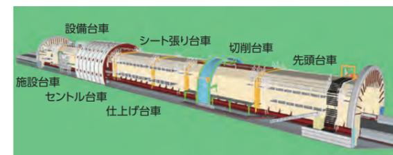
トンネル覆工再生工システムイメージ図
