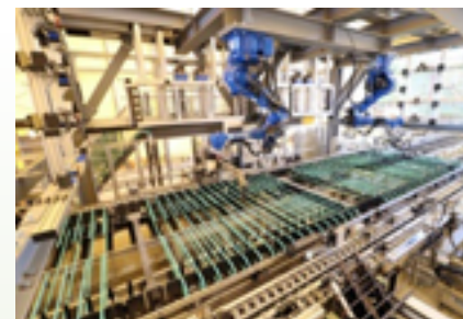
PC床版の鉄筋組立作業の様子(能登川工場)
