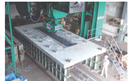
成果事例写真：床版輪荷重試験
