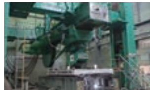
輪荷重走行試験(100年程度の疲労耐久性を有することを確認)
