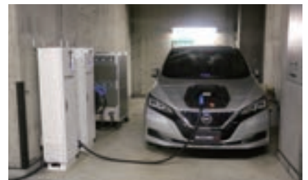
電気自動車から超高層住宅のエレベーターへ電源を供給
