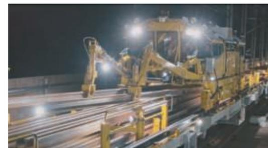
新幹線レール交換の、運搬、積卸し、溶接、交換の一連作業を、ひとつのシステムで効率的に施工することができる世界初の機械編成群
