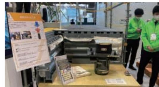
ホーム上家の工事において、柱と杭を一体化することで基礎コンクリートを小さくし、施工性の向上とコスト削減を図る工法
