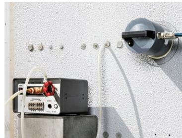
ダブルチャンバー法での測定状況
