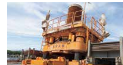
日本車両製造製全回転チューピング装置RT200HH型
