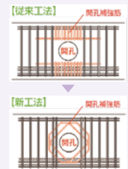
図2 開孔部の補強方法比較
