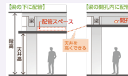
図1 配管の設置位置によるメリット
