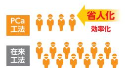
※データは12階建て1棟120戸の集合住宅、WR-PC工法と在来工法を比較したものの
