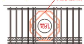
開孔サイズに合う製品を開孔補強筋として設置するのみ
