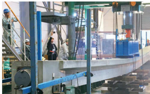
曲げ耐力確認試験状況
