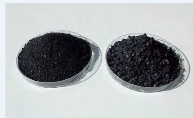
アスファルトと混合するバイオ炭
