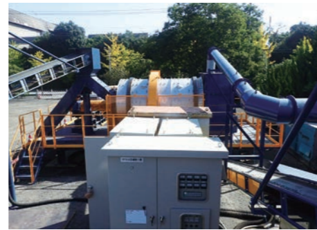
リサイクル事業の強化 (メカニカルグライディング※処理を行う装置) ※機械的(物理的)研削による骨材被膜の除去
