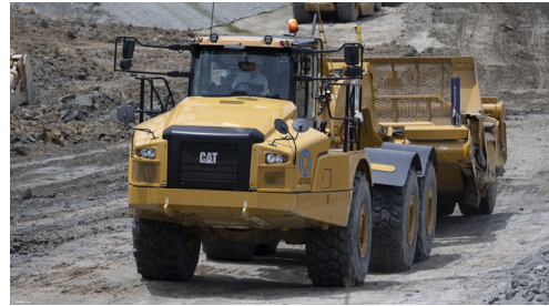
建設機械「スクレーパー」。最適掘削管理・最適運土速度・排土・敷き均し・転圧・品質保証管理をシステム化する取り組みを推進
