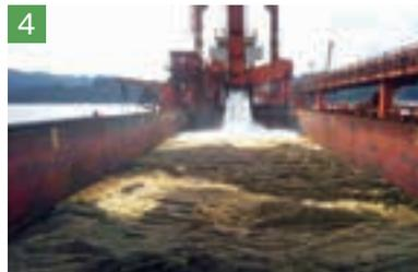
4 ポンプで吸い上げた軽石は、砂採取船の船倉に集積され、
