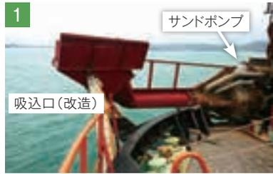
1 サンドポンプの先端に軽石を効率よく回収するため、吸込口を改造し、
