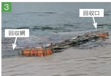
軽石が回収口から回収され、背後に取り付けた回収網に集積される。
