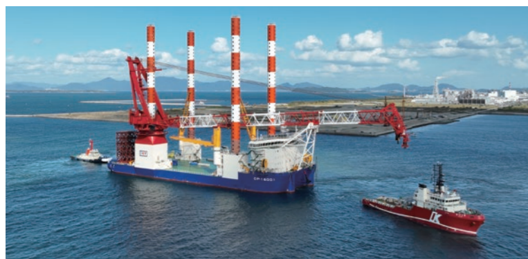
CP-16001 2隻目の大型SEP船(1,600t吊)
