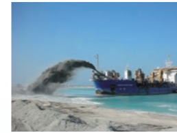
世界最大級の自航式浚渫船「クイーン・オブ・ペンタオーション」(現:アンドロメダV)シンガポール就役(1999)
