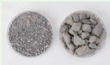
再生細骨材(左)と再生粗骨材(右)
