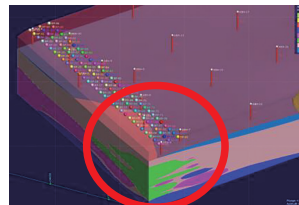
土質調査記録より、3D土質モデルを作成 複雑かつ不均一な土質を可視化
