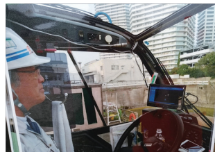
クレーンオペレーター用モニター
