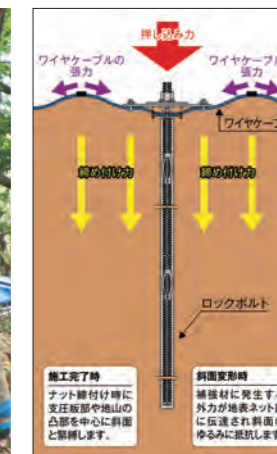
斜面補強メカニズム
