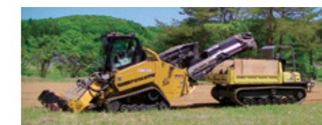
小型・軽量の専用機[PUMA2400]を用いて、農地表層を効率的に削り取りします。 ※[PUMA2400]は、USG社(ドイツ)の登録商標です。
