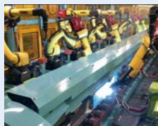
3・4階建住宅に使われる重量鉄骨からなるβ梁の生産能力を動画を使ってご紹介
